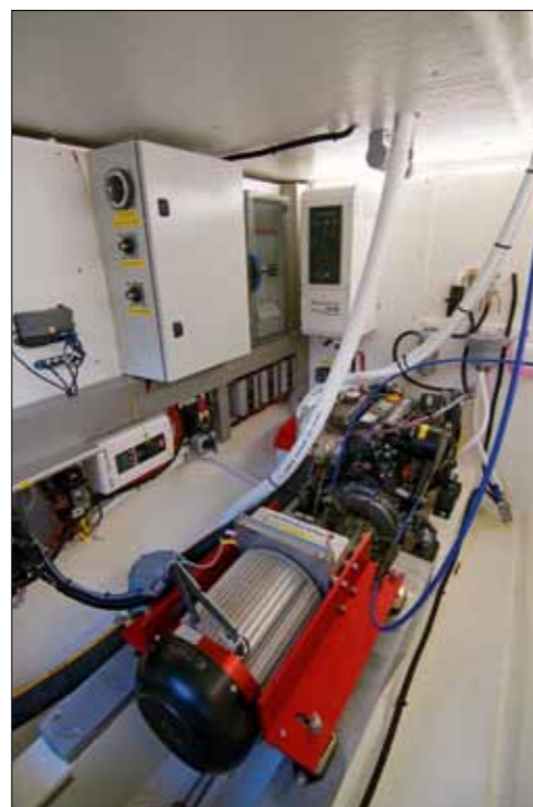
Les moteurs diesel côtoient les électriques dans la version hybride. La vitesse croisière est comprise entre 6 et 8 nœuds selon le modèle.
